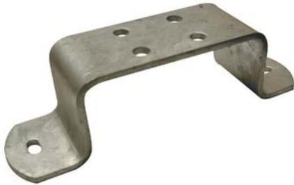
per collegamenti equipotenziali; sezione 60 x 5 mm, con n° 2 fori per il fissaggio piastra, in acciaio zincato a caldo secondo CEI 7-6; adatta per il collegamento con conduttori piatti, bullone M10x25 (vedi pag. 41) e con conduttori tondi, morsetto terminale (vedi pag. 33).
