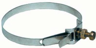
in ottone nichelato; adatta per la messa a terra di tubazioni, per conduttori di sezione massima 6 mm<sup>2</sup>; bullone in ottone M4 x 12 mm.
