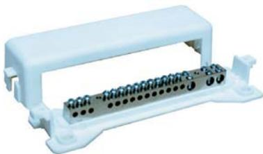
per collegamenti equipotenziali; con coperchio e base in plastica piombabile, ingombro 52 x 185 x 43 mm, barra in ottone nichelato sezione 12 x 12 mm e morsetti numerati.
