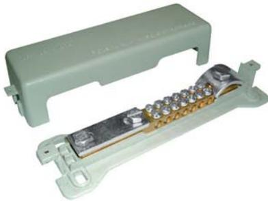
per collegamenti equipotenziali; con coperchio e base in plastica piombabile, ingombro 52 x 185 x 43 mm, barra in ottone sezione 14 x 9 mm e morsetti numerati.
